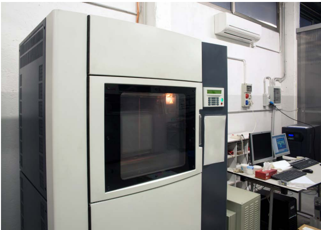
Abb. 39 Anlage für ein pulverbettbasiertes Schmelzverfahren
