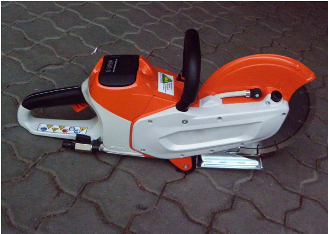
Abb. 42 Mit Lithium-Ionen-Akkus betriebene Trennschleifmaschine
