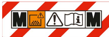
Abb. 12 Kennzeichnungsetikett eines ortsveränderlichen Entstaubers der Klasse M
