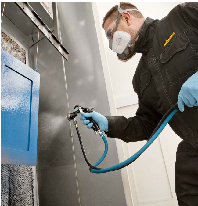
Abb. 26 Lackierarbeiten an einem Spritzstand
