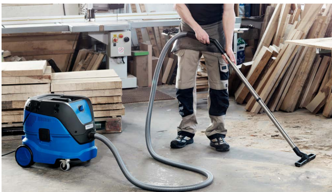
Abb. 19 Reinigung des Arbeitsbereichs mit einem Industriestaubsauger der Staubklasse M
