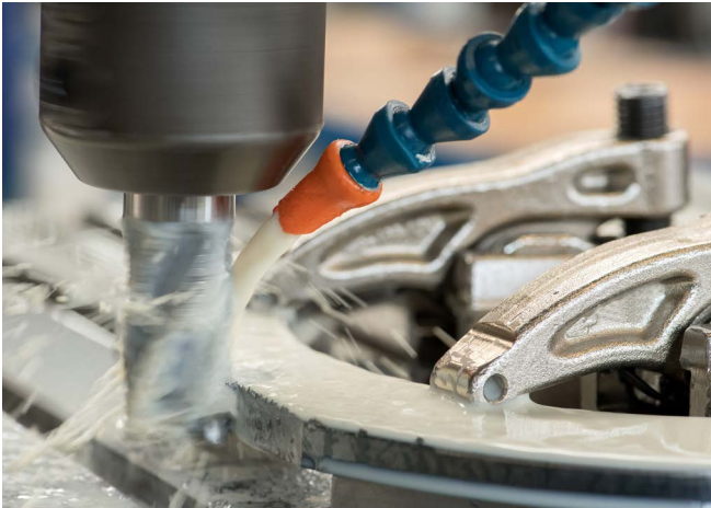
Abb. 23 Kühlschmierstoffanwendung an einer Drehbank
