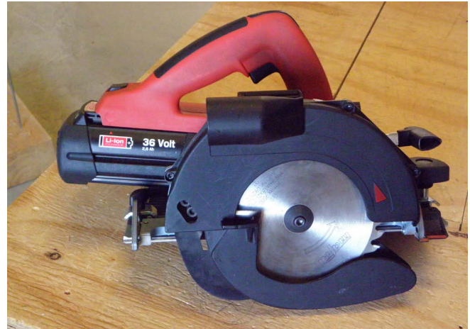
Abb. 43 Mit Lithium-Ionen-Akkus betriebene Akkuhandkreissäge
