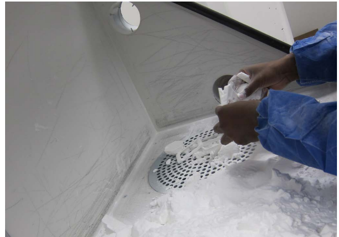
Abb. 40 „Auspacken“ der generierten Bauteile beim pulverbettbasierten Schmelzen
