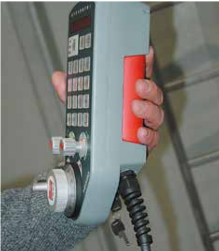
Bild 2-34: Handbediengerät mit Zustimmungstaster (rote Schaltfläche). Mit einem Handbediengerät kann man in die Steuerung – insbesondere Automatiksteuerung einer Maschine – eingreifen, um den Zerspanungsprozess ggf. sofort zu unterbrechen oder zu korrigieren
