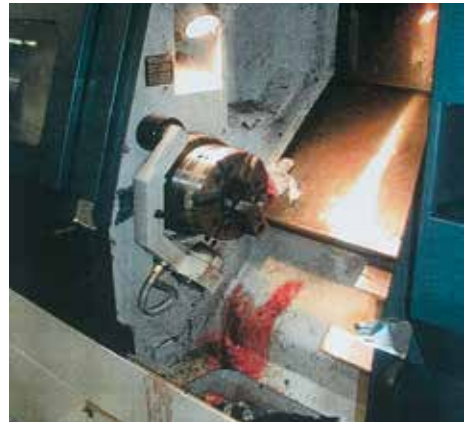
Bild 9-6: „Offener“ Arbeitsraum CNC-Drehmaschine
