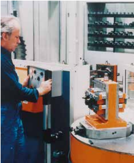
Bild 2-32: Auslösung eines Materialtransportes durch ortsbindende Zweihandbedienung
