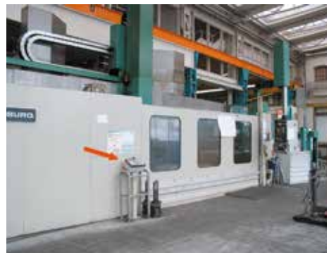
Bild 2-38: Große eingehauste Vertikal-Drehmaschine mit Freifahrereinrichtung
