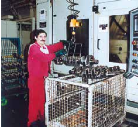
Bild 5-4: Kurbelwellenbeladung mittels Hebehilfe
