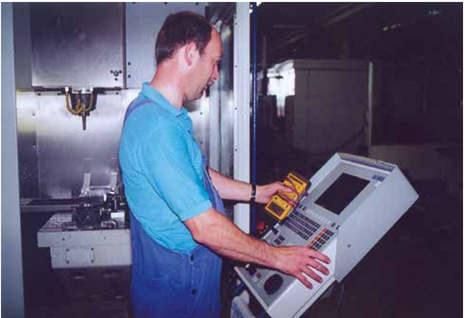
Bild 2-56: Das Fehlerprotokoll informiert über die Störungsursache
