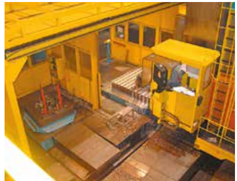
Bild 2-47: Hubarbeitsbühne an großem Bearbeitungszentrum für Pendelbearbeitung. Die Hubarbeitsbühne kann in jeder Position über eine Steigleiter sicher verlassen werden
