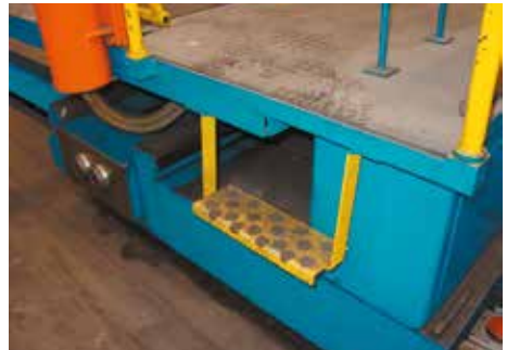
Bild 2-55: Sicherer Aufstieg auf Bedienstand einer Horizontal-Drehmaschine
