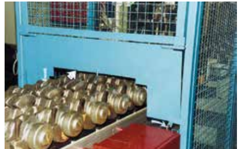
Bild 2-30: Einlaufschutz am formschlüssigen Transportsystem mit hoher Zugkraft
