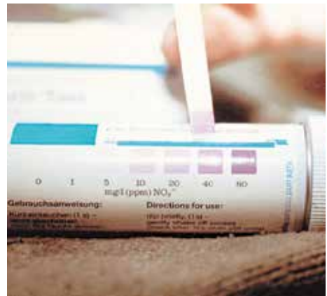
Bild 4-5: Prüfung des Nitritgehaltes durch Farbvergleich
