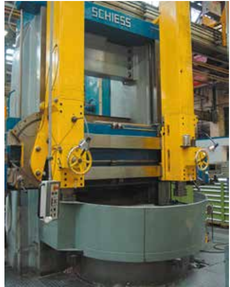
Bild 2-49: Vertikal-Drehmaschine (ältere Bauart) mit trennender Schutzeinrichtung
