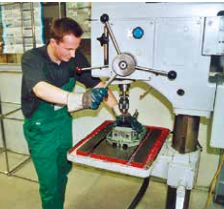
Bild 2-22: Verbotswidriges Arbeiten mit Handschuhen (nachgestellt)
