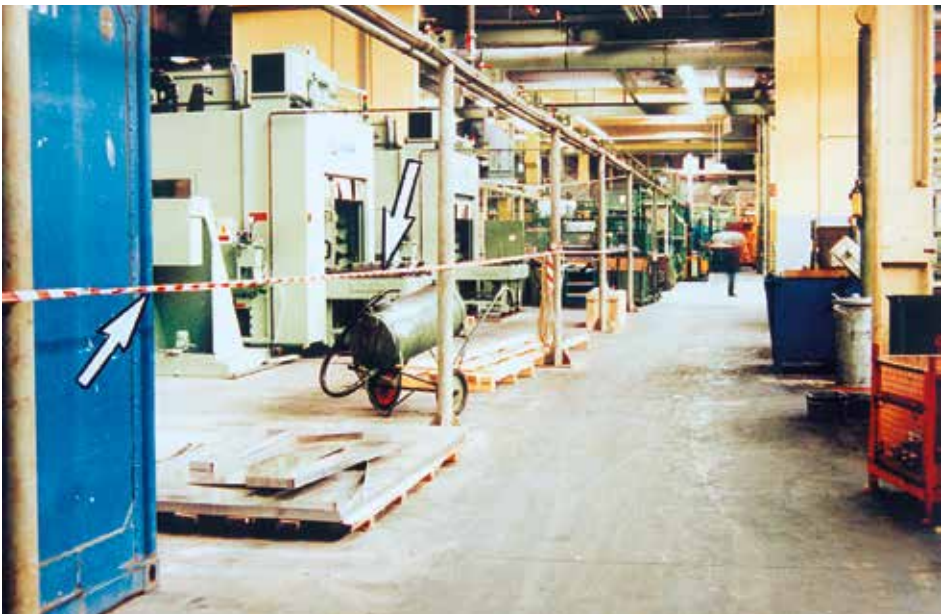
Bild 2-12: Abgrenzen der Probelaufbereiche
