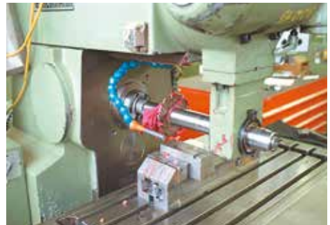
Bild 9-8: Haut- und Kleidungsreste am ungeschützten Scheibenfräser
