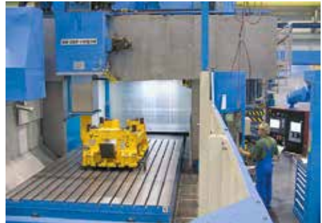
Bild 2-35: Großes Bearbeitungszentrum; Automatikbetrieb bei geschlossener Umhausung. Links im Bild ist eine Fernsehkamera zu sehen, mit welcher der Innenraum der Maschine (Spindel mit Fräsbahn) auf einem Bildschirm am Hauptbedienfeld abgebildet wird
