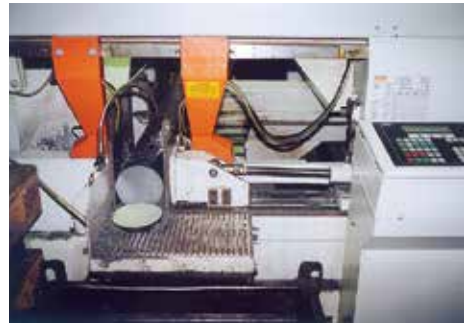
Bild 2-29: Betätigungselemente an der rechten Seite einer Säge außerhalb des Gefahrenbereiches
