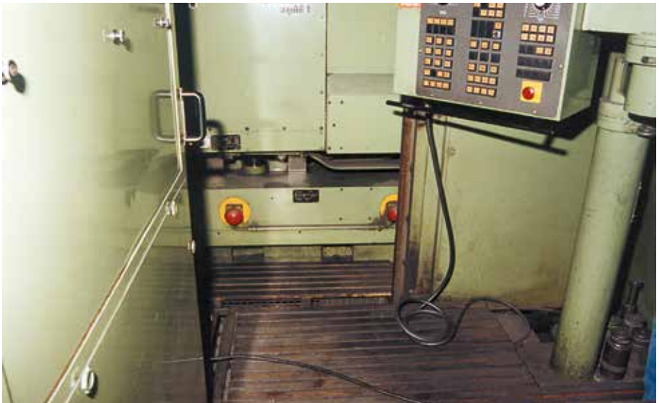
Bild 2-16: Zusätzliche Not-Aus-Schalter im Fußbereich an einem Bearbeitungszentrum
