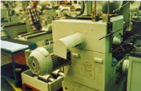
Bild 2-24: Spänefangereinrichtung an einer Drehmaschinenhohlwelle
