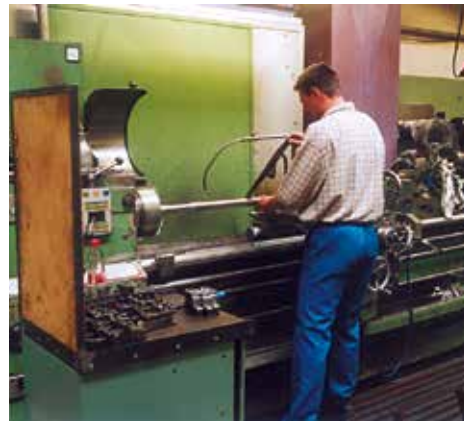
Bild 2-21: Gefahr des Erfasstwerdens an glatten, rundlaufenden Wellen
