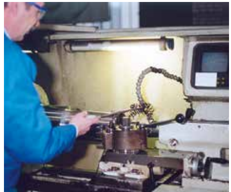
Bild 7-1: Verboten: Entfernen von Fließspänen mit Spänehaken ohne Handschutz (Bild nachgestellt)
