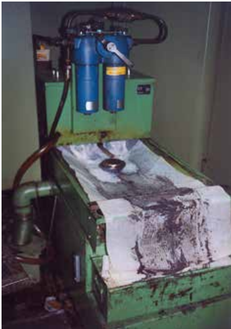
Bild 2-5: Gesundheitliche Gefährdungen an einer Filteranlage
