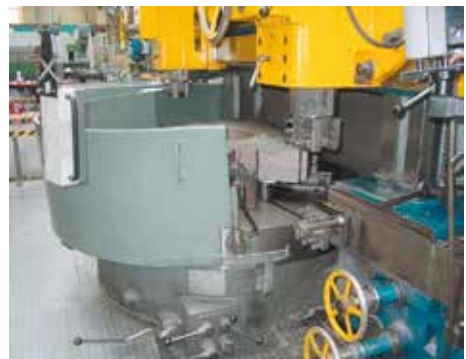
Bild 2-50: Vertikal-Drehmaschine mit trennender Schutzeinrichtung (Schiebemechanismus)
