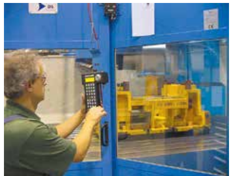
Bild 2-36: Großes Bearbeitungszentrum; unzureichende Sicht von außerhalb auf die Spindel bzw. die Fräsbahn des Fräasers. In vielen Fällen kann eine Fernsehkamera eine ausreichende Bildinformation von Spindel und Fräsbahn auf einen Bildschirm nach außen übertragen, sodass ein Betreten des Gefahrenbereichs der Maschine bei laufendem Betrieb nicht notwendig ist
