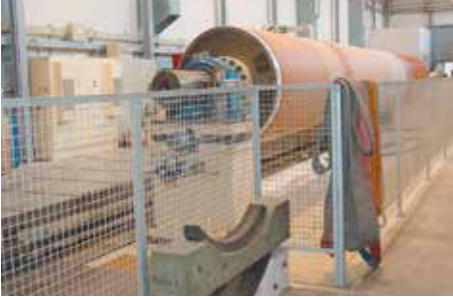
Bild 2-51: Horizontal-Drehmaschine mit rückwärtiger Umzäunung (mindestens 1,4 m hoch)
