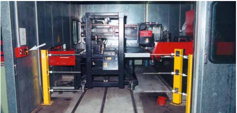
Bild 2-42: Aktive Schutzzone innerhalb eines automatisierten Fertigungssystems mit Einweglichtschranken in dreistrahliger Ausführung (Maße: 0,3 m; 0,7 m; 1,1 m).
