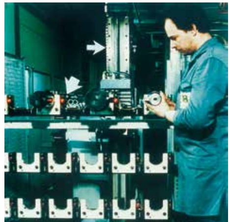
Bild 2-41: Räumliche Trennung in Werkzeugwechselstation durch Werkzeugregal
