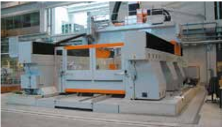
Bild 2-53: Bearbeitungszentrum mit kompletter Einhausung. Im Vordergrund sind die Schienen eines Transportsystems für Werkstückpaletten erkennbar
