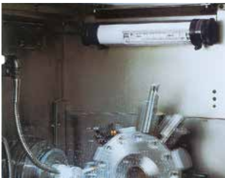
Bild 5-3: Maschinenschutzrohrleuchten in Werkzeugmaschinen
