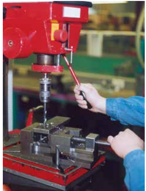
Bild 7-3: Vermeidung unnötiger Risiken beim Bohren
