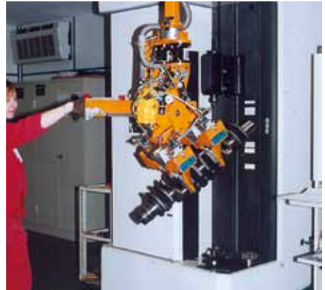
Bild 5-5: Positionierung der Kurbelwelle mittels Balancer
