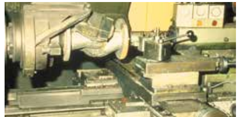
Bild 9-2: Drehmaschine mit sicherheitswidriger Spanneinrichtung, Beispiel 2
