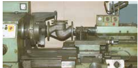
Bild 9-1: Drehmaschine mit sicherheitswidriger Spanneinrichtung, Beispiel 1
