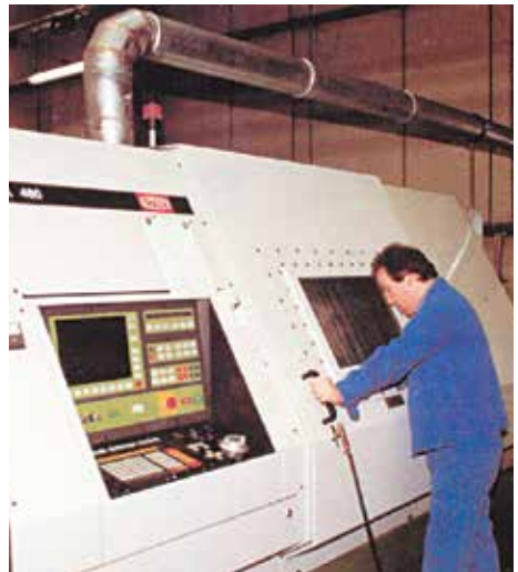
Bild 4-1: Absaugung an einer CNC-Drehmaschine
