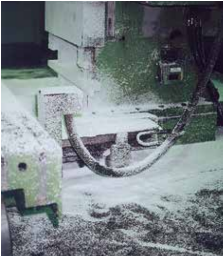
Bild 2-3: Gefährdung durch Ausrutschen
