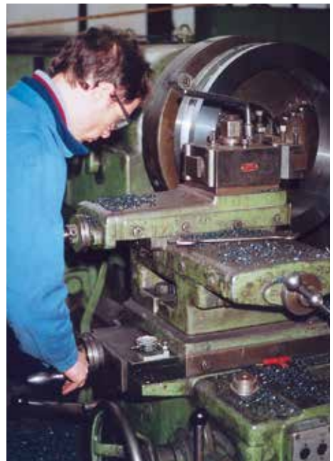
Bild 2-4: Gefährdung durch wegfliegende Späne beim Drehen
