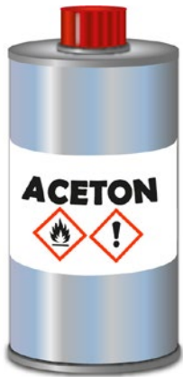
Abb. 3.13 Vereinfachtes Kennzeichnungsetikett für Aceton auf einem Behälter
