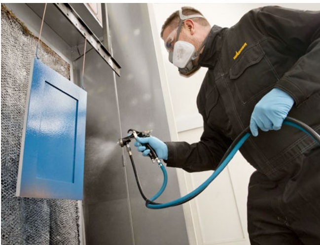
Abb. 12.1 Lackierer beschichtet ein Werkstück an einer Spritzwand im Sprühverfahren
