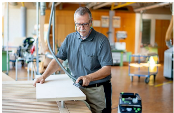
Abb. 12.6 Tischler bearbeitet Werkstück mit einem abgesaugten Handschleifklotz
