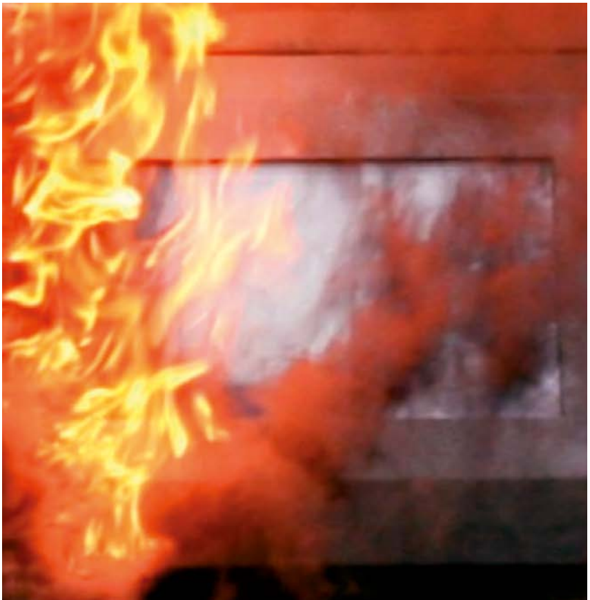
Abb. 23 Flammenaustritt am Türlabyrinth
