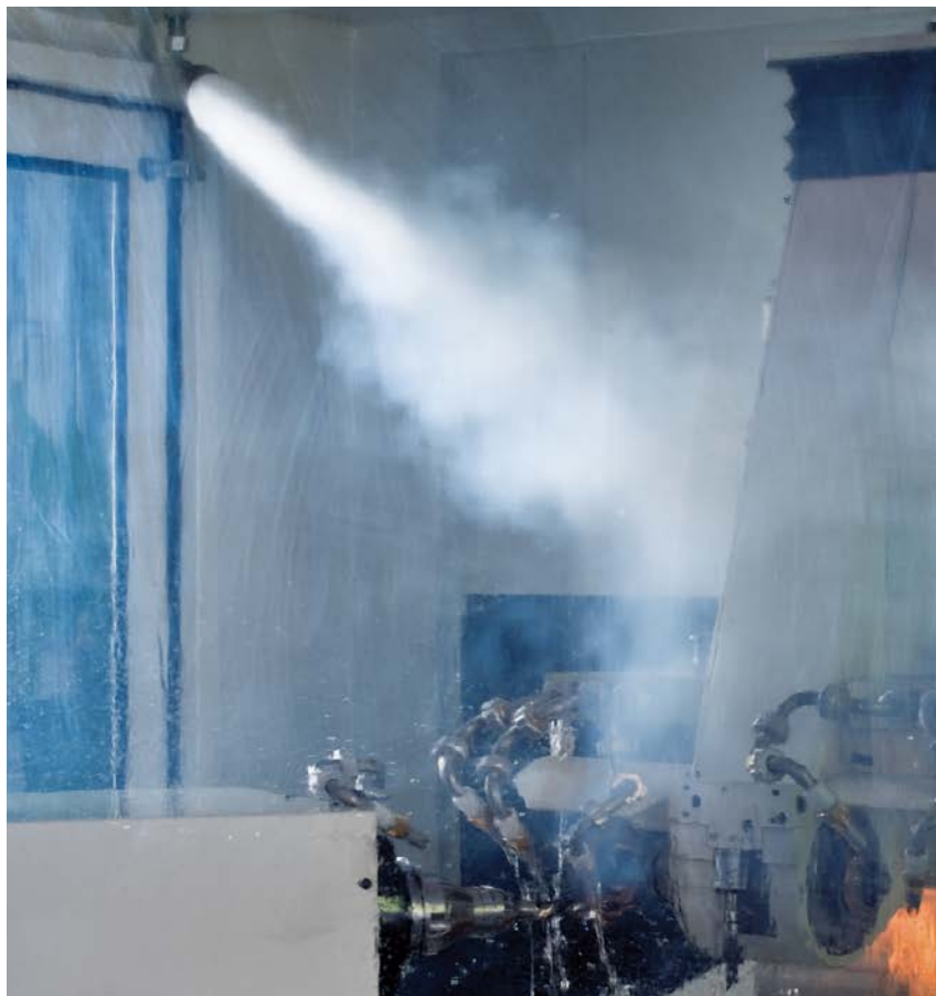
Abb. 48 Löschen nach Brand-Detektion
