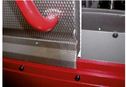
Abb. 26 Bereich Schiebetür mit zusätzlichem Labyrinth für Bearbeitung mit Öl
