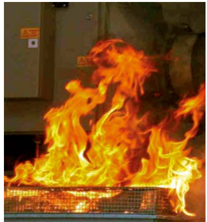
Abb. 44 Nachbrand nach erfolgter Löschung
