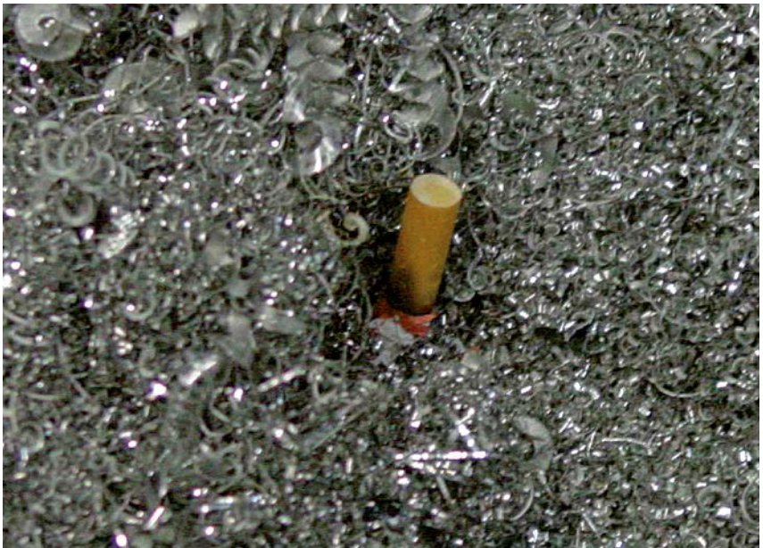
Abb. 56 „Zündquellen“ im Spänebehälter
