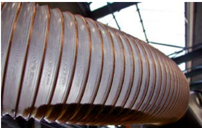
Abb. 36 Ansammlung von Öl in Absaug-schlauch
