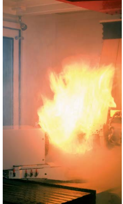
Abb. 7 Reaktion um Schleifspindel
