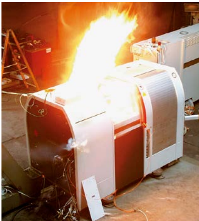
Abb. 43 Flammenaustritt aus Druckentlastungsklappe
