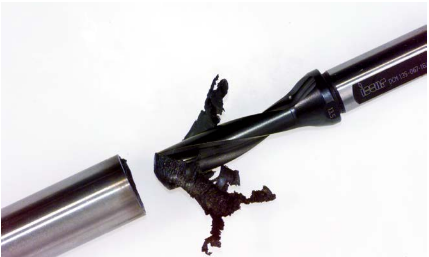
Abb. 20 Heißgelaufener Bohrer als Zündquelle
