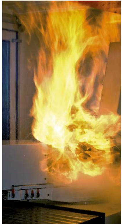
Abb. 47 KSS-Entzündung beim Schleifen mit Folgebrand
