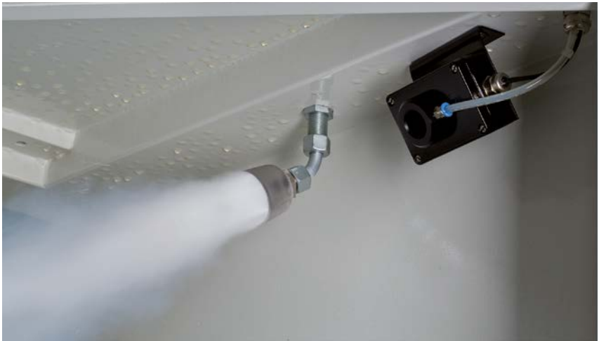
Abb. 54 Löschdüse im Einsatz
