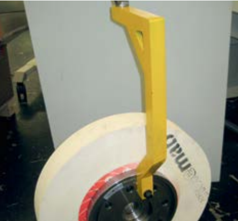
Abb. 12 Schleifscheibentransport mit Lastaufnahmemittel
