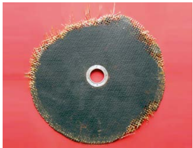
Abb. 24 Trennschleifscheibe nach Rückschlag
