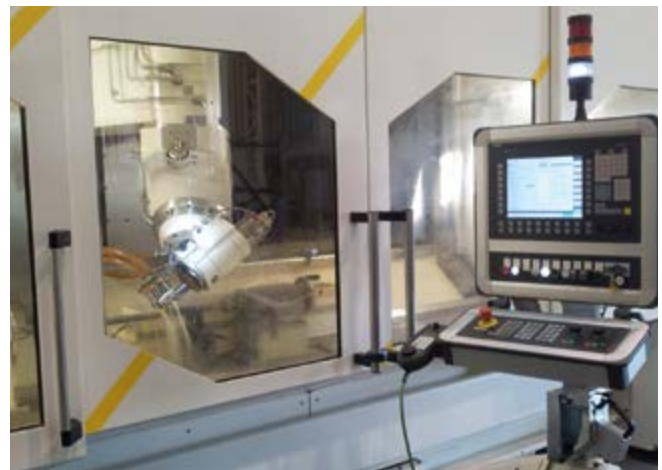
Abb. 10 Vollverkleidung des Bearbeitungsraumes
