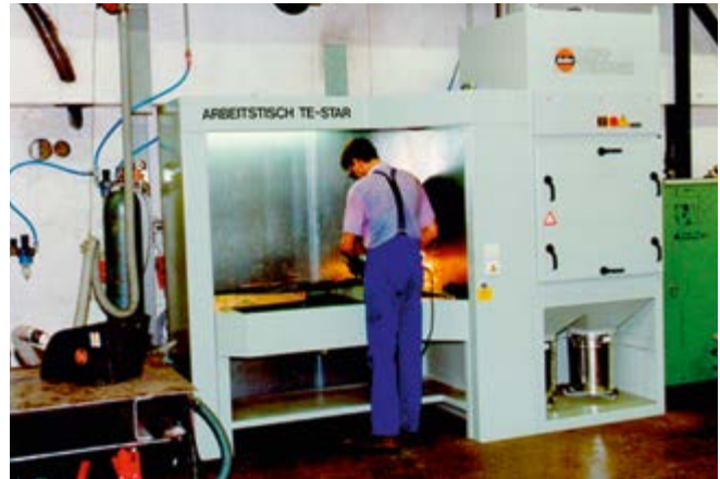
Abb. 28 halboffenes Erfassungssystem für Schleifarbeitsplatz
