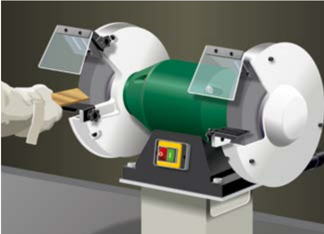
Abb. 8 Schleifbock mit nachstellbarer Werkstückauflage und Stirmschieber
