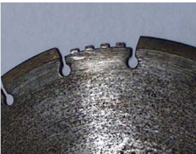
Abb. 25 Diamanttrennschleifscheibe mit abgerissenem Segment
