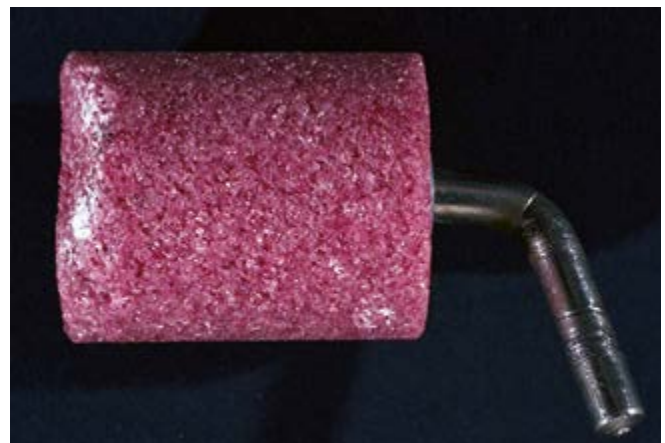
Abb. 19 Schleifstift mit abgelenktem Schaft
