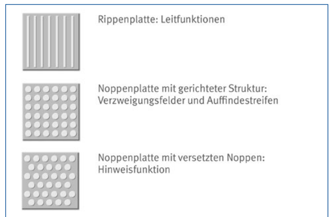
Abb. 8 Komponenten von taktilen Bodenindikatoren
