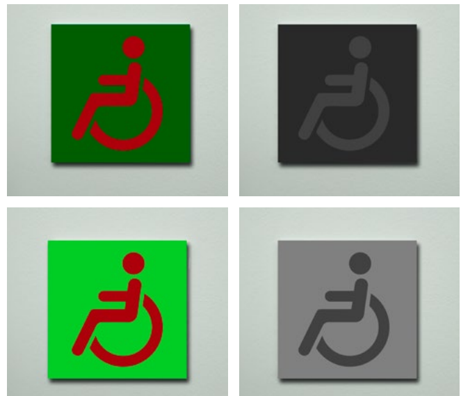
Abb. 5 Gegenüberstellung Farb- und Leuchtdichtekонтast (Grauwertkонтast)
