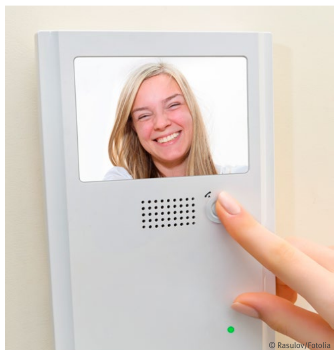
Abb. 15 Türkommunikationsanlage mit Videoterminal
