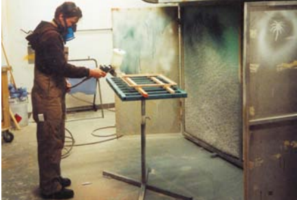
Abb. 7 Lackierarbeiten an einem Spritzstand
