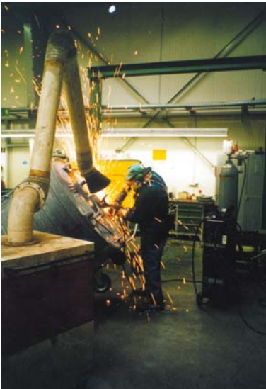
Abb. 5 Schweißarbeitsplatz mit Absaugung
