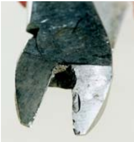
Bild 10-5: Bei qualitativ schlechtem Werkzeug können falsche Werkstoffwahl und falsche Härteverfahren bei größerer Belastung zu Ausbrüchen oder gar Abbruch der kompletten Schneide führen
