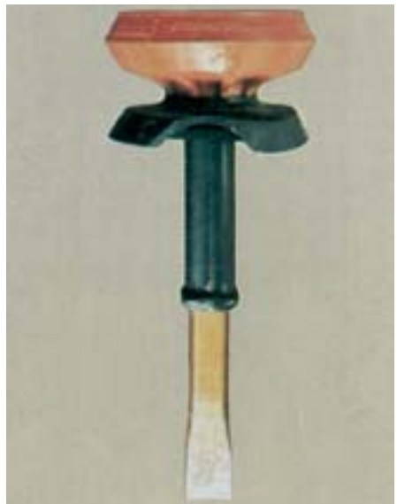
Bild 3-7: Handschutz mit Splitterfangkorb für schwere Meißelarbeit
