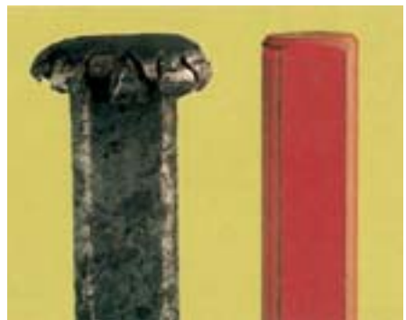
Bild 3-1: Das Schlagende des Meißels ist breit geschlagen und bildet den „Bart“. Splitter, die von diesem Bart abspringen, können Verletzungen herbeiführen
