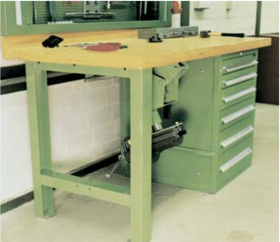
Bild 15-2: Parallelschraubstock auf Klappgerät unter die Werkbank geschwenkt; die Arbeitstischfläche steht so voll zur Verfügung
