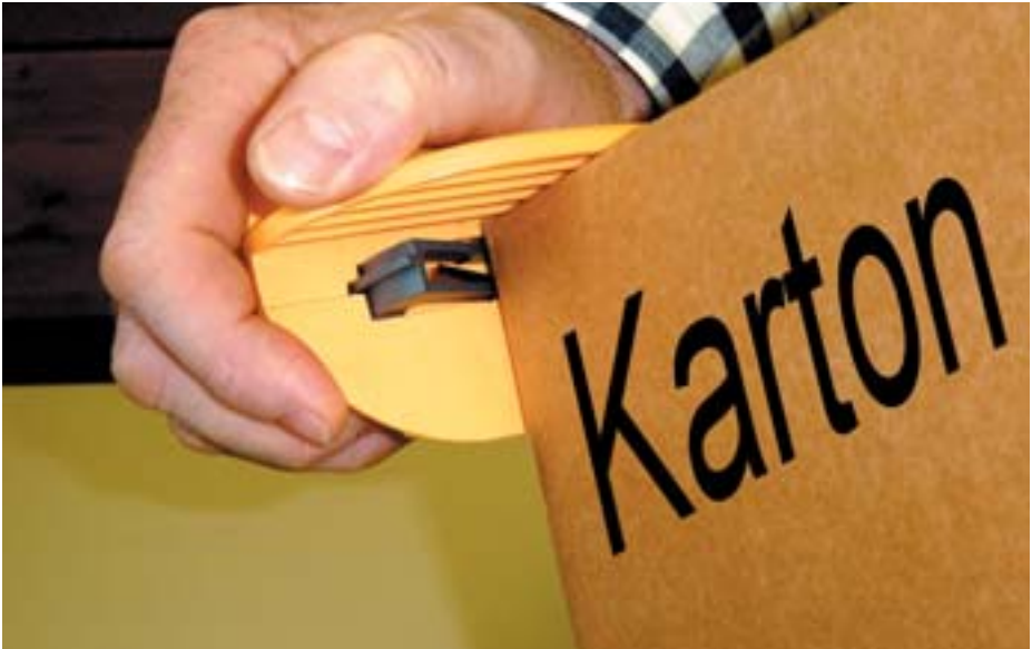
Bild 12-4: Messer mit beweglichem Schutzkragen als Klingenschutz
