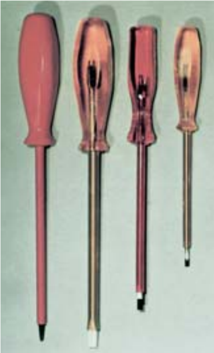
Bild 5-5: Normale Schraubendreher, nicht geeignet für Arbeiten an elektrischen Anlagen (siehe auch Bild 14-5)
