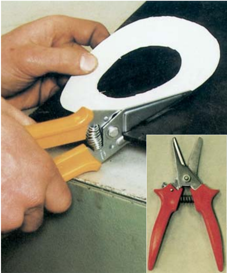
Bild 9-3: „Stumpfe“ Scheren mit abgerundeter Spitze und Zuhaltung verringern die Verletzungsgefahr und sind vielseitig zu verwenden
