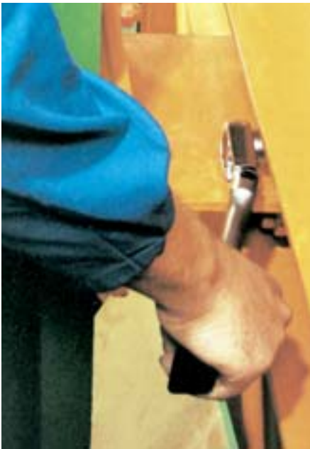
Bild 7-4: Gelenkknarre mit Arretierung
