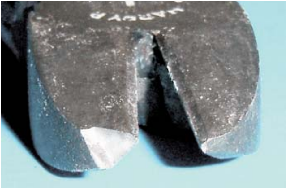
Bild 10-4: Zu hoher Härtewert der Schneiden führte zum Abbruch der Spitze
