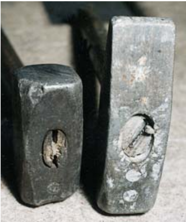
Bild 2-12: Unzureichender Kantenbruch sowie erhebliche Absplitterung durch Kantenschlag, außerdem: Fäustel links – fehlende Verkeilung des Stiels, Schlosserhammer rechts – loser, teils herausgezogener Stiel nach Austrocknung
