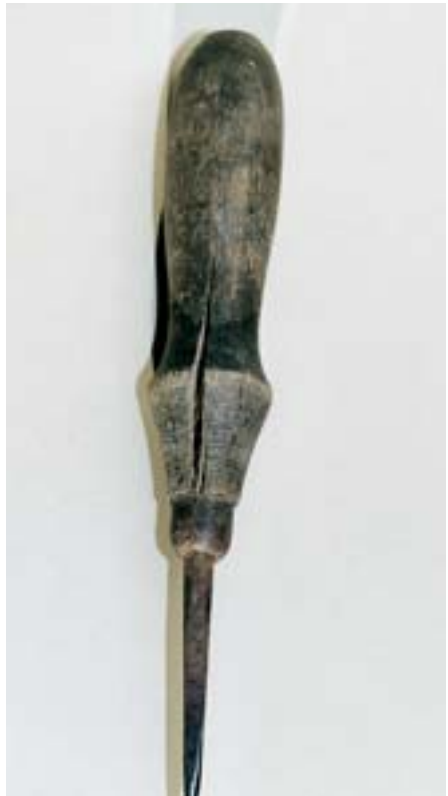
Bild 5-8: Gespaltene Holzgriffe lassen schnell eine Lockerung des Werkzeuges im Griff aufkommen und sind auszutauschen
