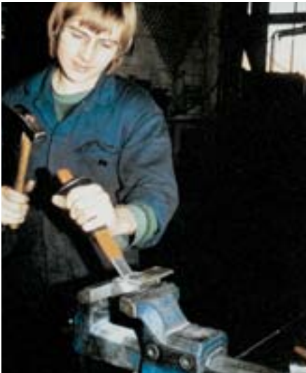
Bild 3-4: Meißeln mit Handschutz und Schutzbrille
