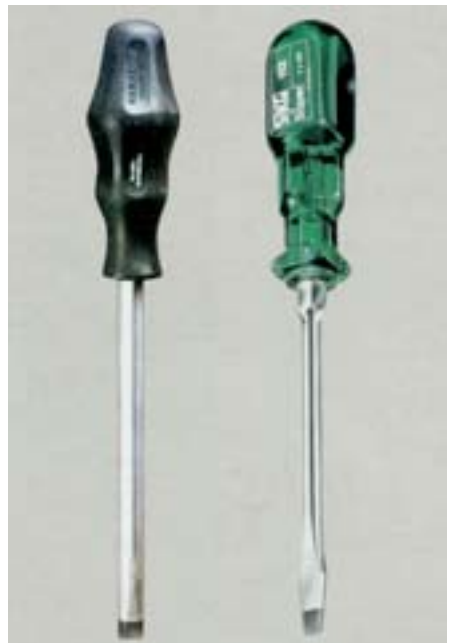
Bild 5-6: Griffe der Schraubendreher sind mehrkantig und ergonomisch der Form der Hand angepasst
