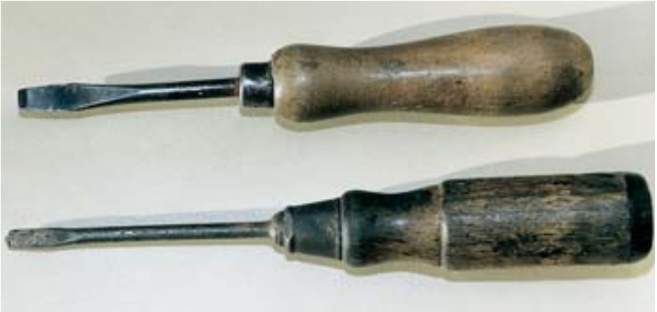
Bild 5-9: Ausbrüche am Arbeitsende der Schraubendreherklinge des unteren Werkzeuges. Dieser Schraubendreher besitzt eine durch das Heft geführte Klinge, siehe auch Bild 5-1. Oberer Schraubendreher in ordnungsgemäßem Zustand
