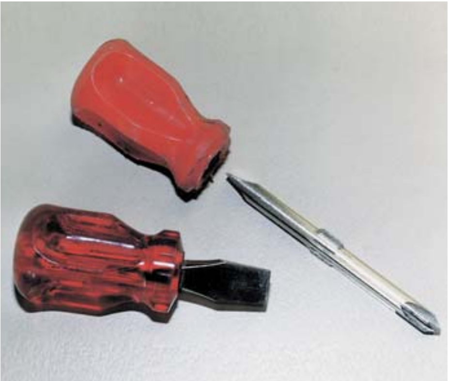
Bild 5-2: Schraubendreher in sehr kurzer Ausführung. Der obere mit austauschbarer Klinge
