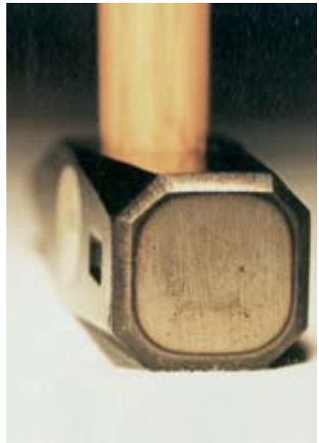
Bild 2-14: Hammerbahn mit induktiv angelassener Randzone und korrektem Kantenbruch
