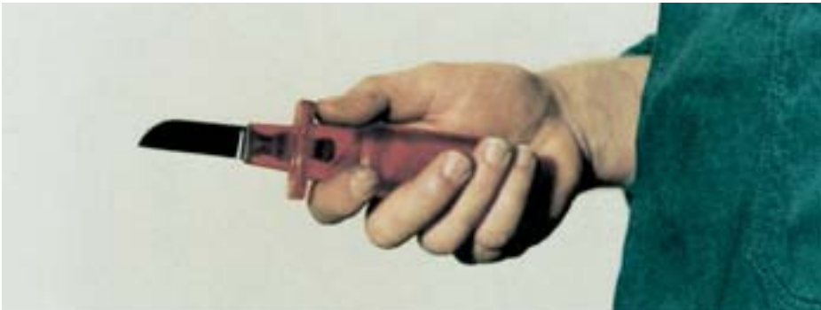
Bild 12-6: Kabelmesser nach DIN EN 60900, VDE 0682-201 „Arbeiten unter Spannung, Handwerkszeuge zum Gebrauch bis AC 1000 V/DC 1500 V“; Umlaufende Wulst verhindert das Abgleiten der Finger in Richtung Klinge
