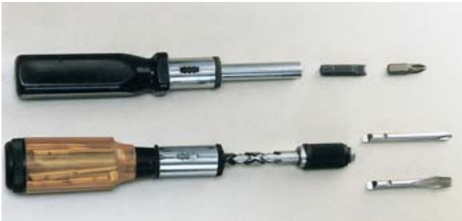
Bild 5-3: Oberes Werkzeug mit rückdrehbarem Griff und Einsatz von so genannten Bits unterschiedlicher Form, Drillschraubendreher nach DIN 7432 mit verschiedenen Werkzeugeinsätzen und Griffmagazin
