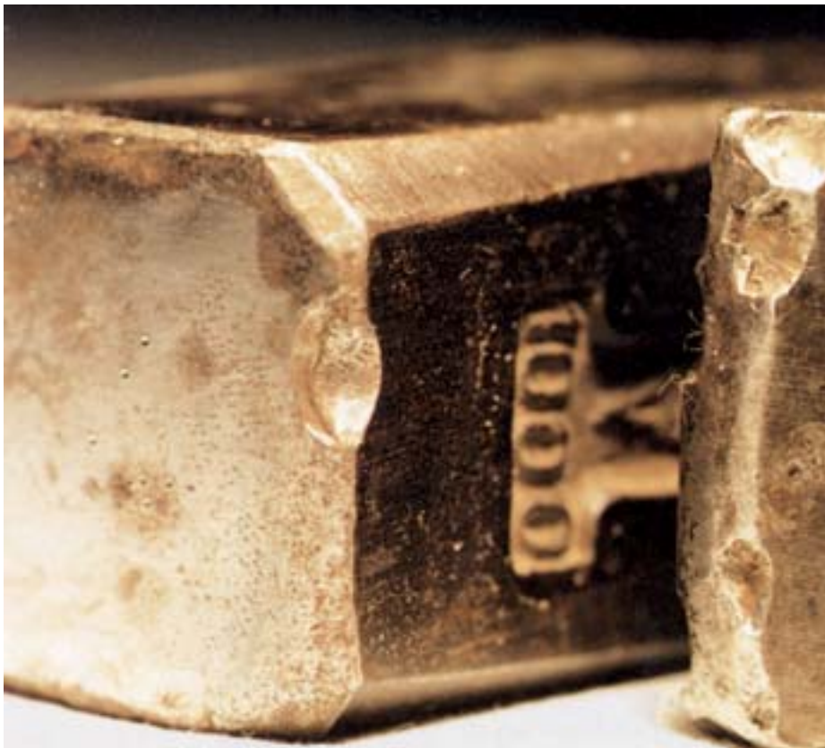
Bild 2-1: Ausscherungen von Stahlspittem aus Hammerbahn und -pinne von Schlosserhämmern
