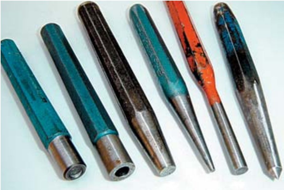
Bild 4-1: Von links nach rechts: Nietkopfmacher DIN 6534, Nietenzieher DIN 6534, Splinttreiber groß und klein, Durchschläger und Körner
