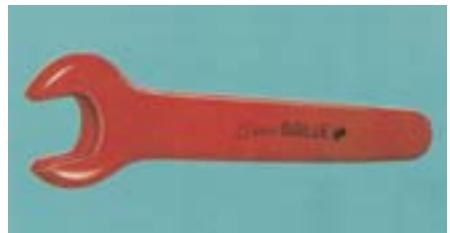
Bild 14-6: Einmaulschlüssel mit Isolation nach VDE für Arbeiten bis 1000 V Wechselspannung bzw. 1500 V Gleichspannung
