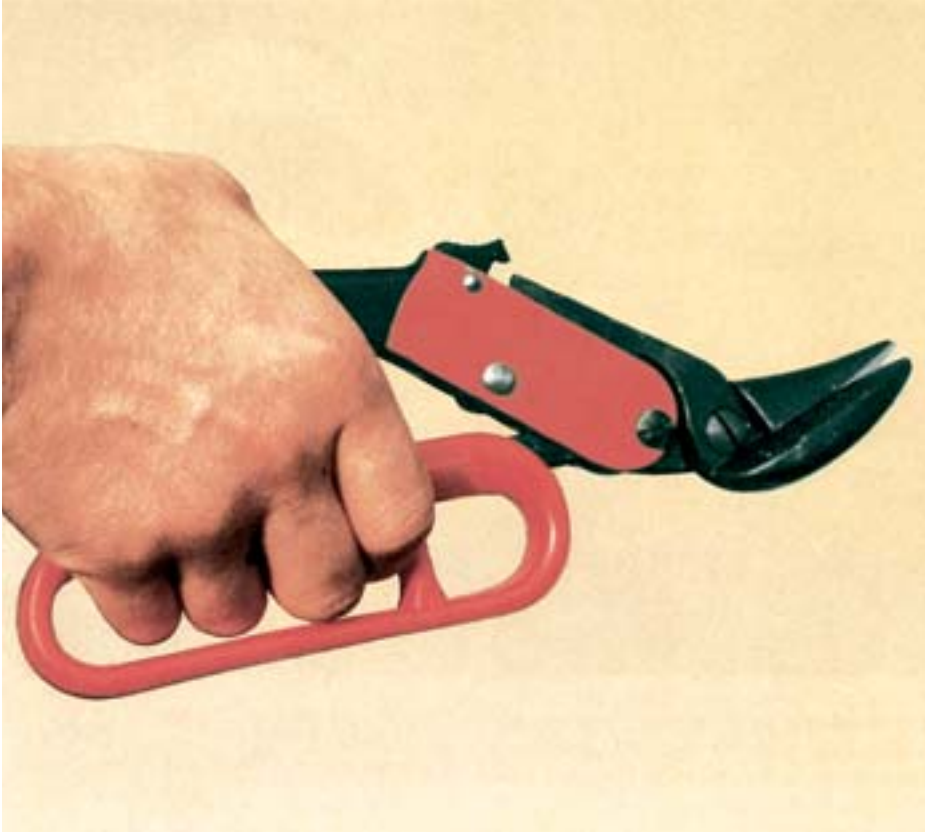
Bild 9-2: Bei dieser Blechschere kann sich die Hand an den scharfen Kanten der Schnittlinie nicht mehr verletzen
