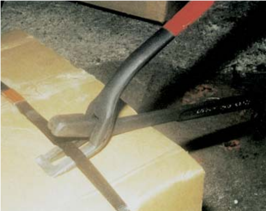
Bild 10-1: Dieser Bandschneider schneidet das unter Spannung stehende Band und klemmt es zugleich so, dass es nicht gefährlich aufspringt
