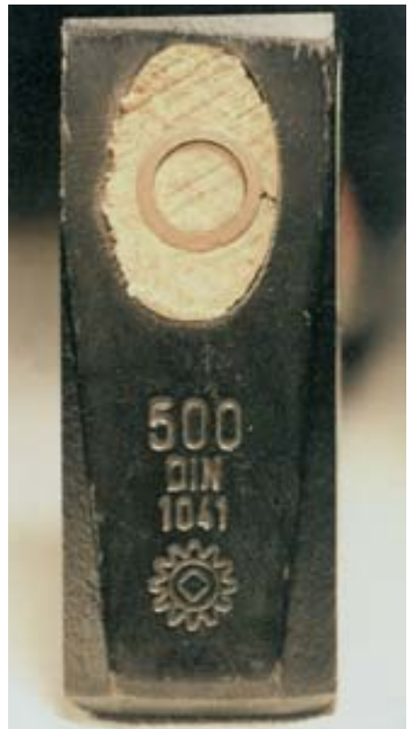
Bild 1-1: Kennzeichnung eines Hammers nach DIN. Von oben nach unten: Hammergewicht in Gramm, Nummer der Norm des Hammers und Herstellerkennzeichen
