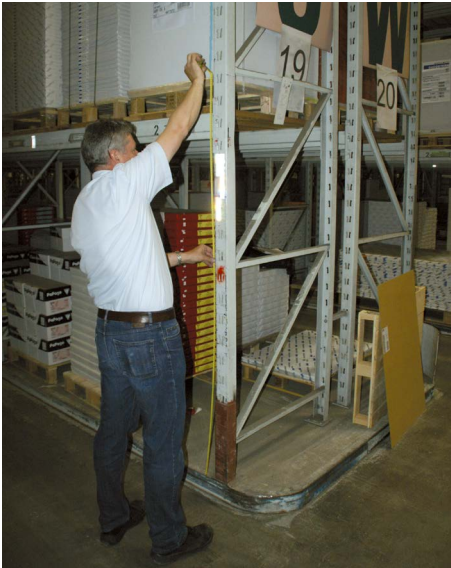
Abb. 6 Überprüfung der Fachhöhe
