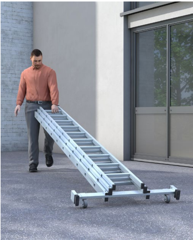
Abb. 67 Ergonomischer Transport schwerer Leitern mittels Transportrollen
