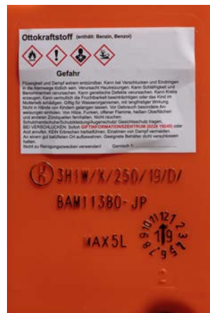
Abb. 3 Kunststoff-Kanister UN-codiert mit Prägestempel, BAM-Zulassung Herstellungszeitraum: Dezember 2019
