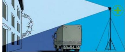
Hoch angeordnete Lichtquellen verringern die Schattenbildung.
