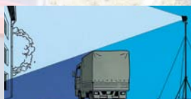
Hoch angeordnete Lichtquellen verringern die Schattenbildung.
