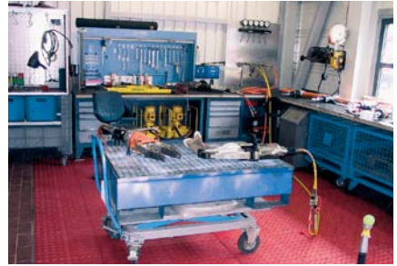
Höhenverstellbarer Arbeitsplatz und Transportmöglichkeit für Instandhaltungsarbeiten an hydraulischen Rettungsgeräten
