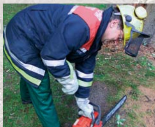
Beim Anwerfen die Motorsäge sicher abstützen und festhalten
