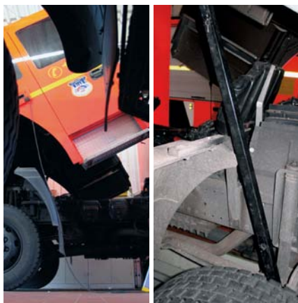
Gekipptes Führerhaus ... mit Sicherung gegen unbeabsichtigtes Absinken
