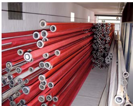
Schlauchtrocknung im Turm
