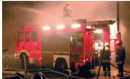
Fahrzeug-Umfeldbeleuchtung und Lichtmast am Löschfahrzeug zur Einsatzstellenbeleuchtung
