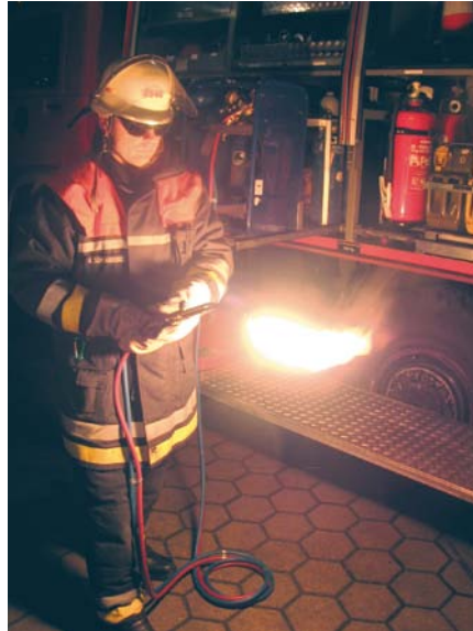
Beim Zünden zuerst das Sauerstoffventil, danach das Brenngasventil öffnen.
