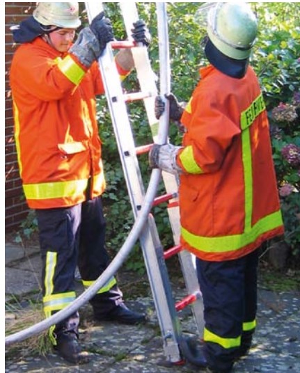
Steckleiter nur mit Einsteckteil verwenden.
