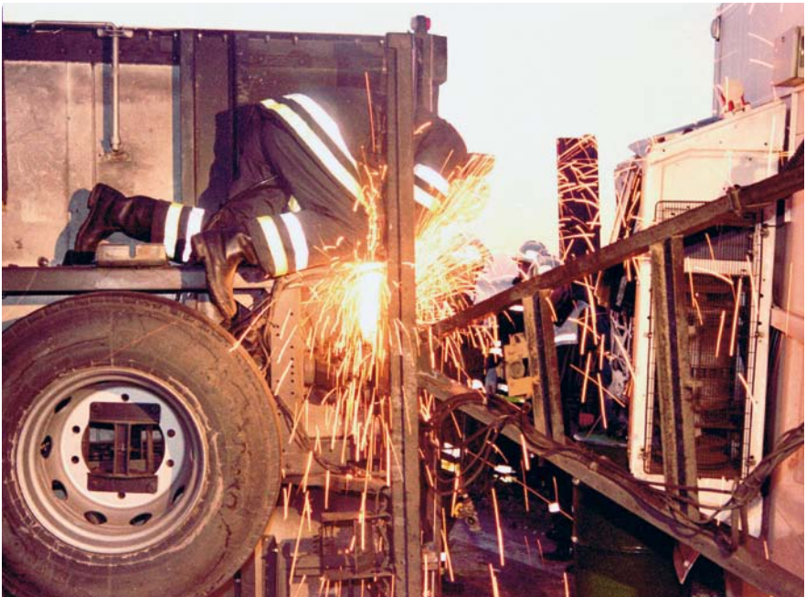
Brennschneiden unter erschwerten Bedingungen nach einem LKW-Unfall
