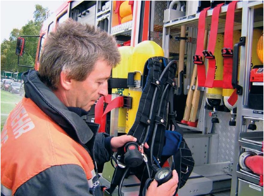
Kontrolle eines Pressluftatmers am Fahrzeug
