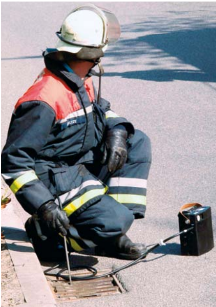
Messgeräte-Einsatz zur Feststellung von Explosionsgefahren
