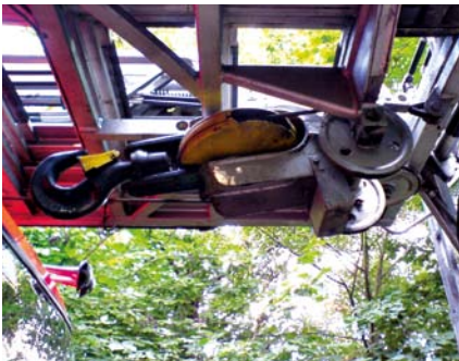
Die Kraneinrichtung des Hubrettungsfahrzeuges – die lose Rolle und die beiden festen Rollen wirken zusammen als Flaschenzug.
