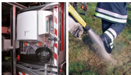
Reinigungsstation am Löschfahrzeug mit fließendem Wasser, Reinigungs- und Pflegemitteln aus Direktspendern und Einmalhandtüchern
