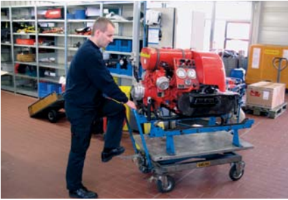
Transportwagen für Tragkraftspritzen mit mechanischer Höhenverstellung
