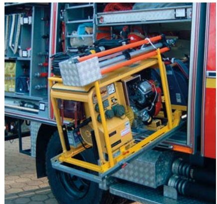
Schräglagerung des Geräteschlittens
