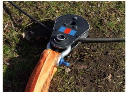
Umlenkung durch feste Rolle
