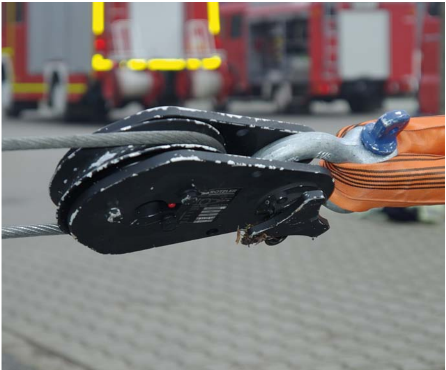
Einsatz einer losen Rolle
