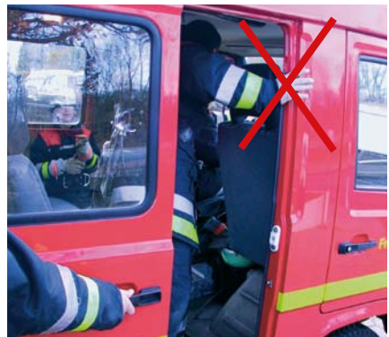
Gefahr durch Schiebetüren – Türholme mit Schließkanten nicht umfassen!
