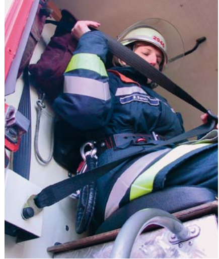
Nachgerüsteter Sicherheitsgurt mit Aufrollautomatik im Mannschaftsraum
