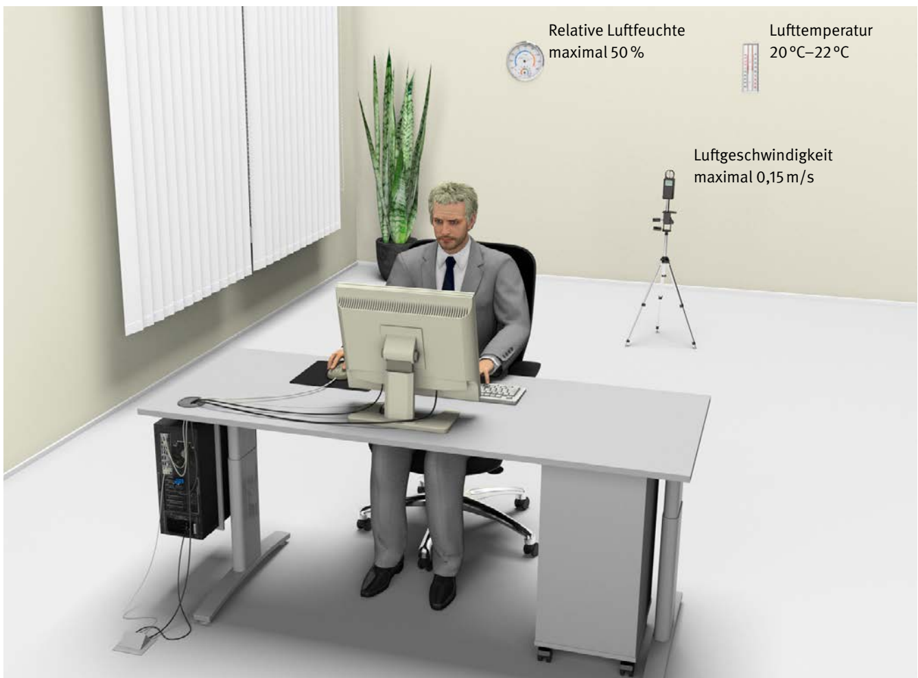
Abb. 4 Übersicht zu Raumklimafaktoren in einem Arbeitsraum
