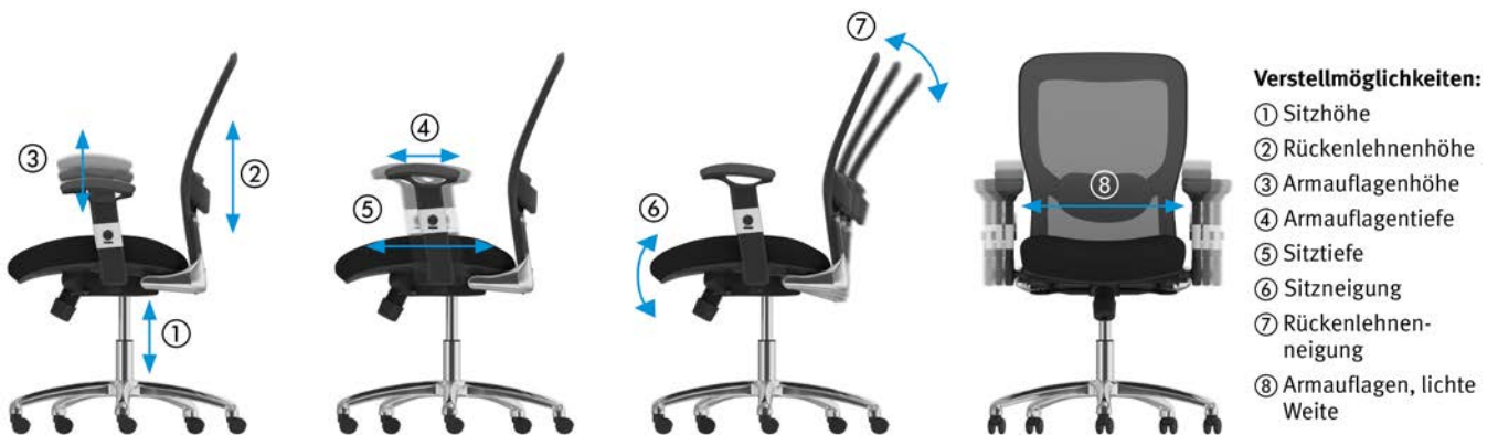
Abb. 12 Verstellmöglichkeiten an einem Büroarbeitsstuhl
