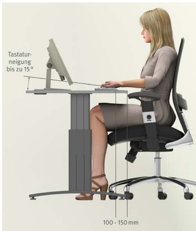
Abb. 16 Anordnung der Tastatur auf der Arbeitsfläche
