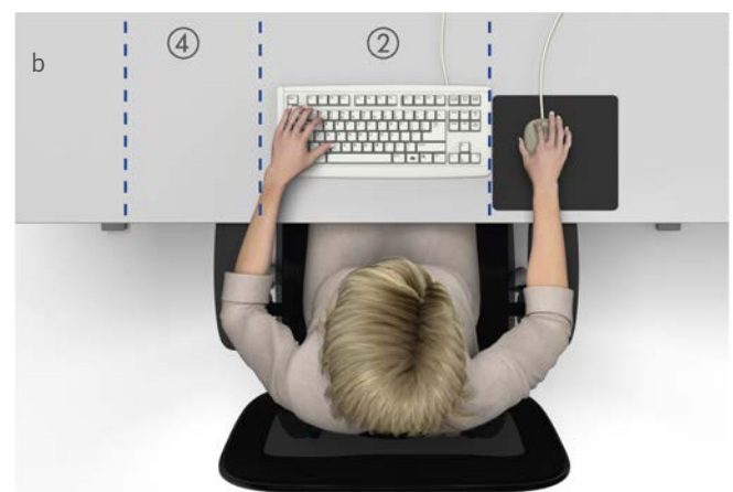
Abb. 17 Position einer Volltastatur (oben) und einer Kompaktastatur mit besserer Erreichbarkeit der Fläche für die Mausbedienung (unten)
